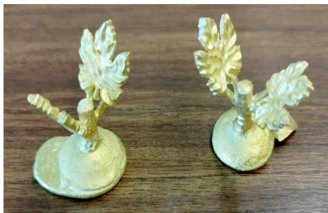
Рис. 1. Отливки, полученные с использованием исследуемой смеси
