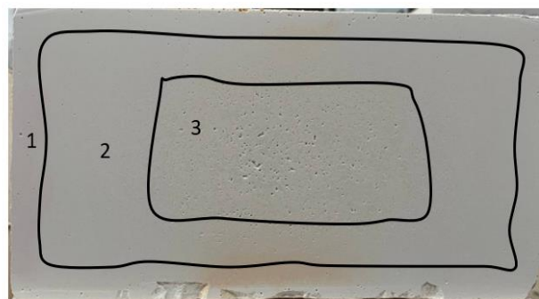
Рис. 5 Зоны различной плотности в конечном огнеупоре
