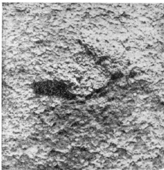
Рис. 1. Излом литого образца с усадочной раковиной
