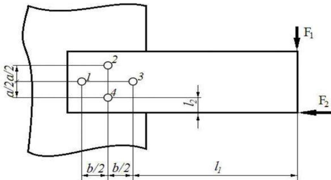
$a = 61$  мм,  $b = 83$  мм,  $l_1 = 160$  мм,  $l_2 = 22$  мм,  $F_1 = 13000$  Н,  $F_2 = 7000$  Н,
