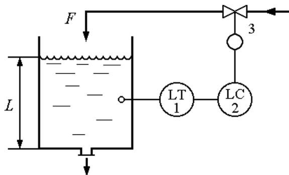
Уровень в напорном баке регулируется изменением притока. В систему автоматического регулирования входят: напорный бак, датчик уровня 1, регулятор 2, исполнительное устройство 3 (исполнительный механизм с регулирующим клапаном). Измерительный прибор и исполнительное устройство имеют передаточные функции
