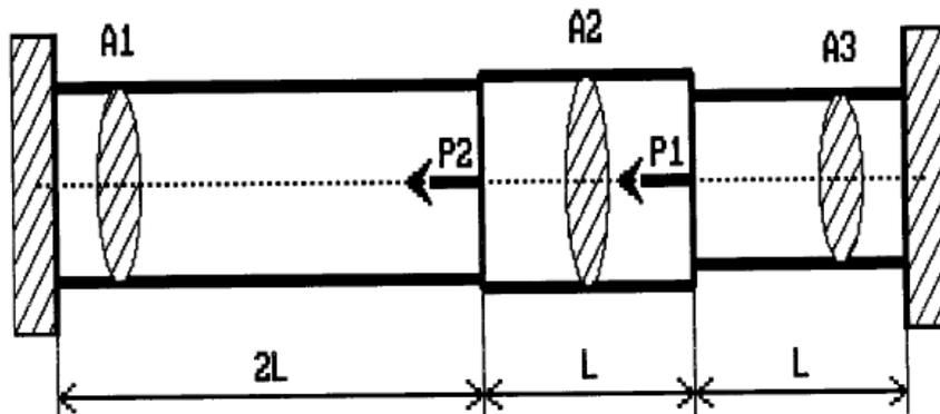
2. Пример задачи к контрольной работе № 2 «Расчет на прочность или жесткость статически определимой балки». Содержит 1 задачу (максимальная оценка 10 баллов).
