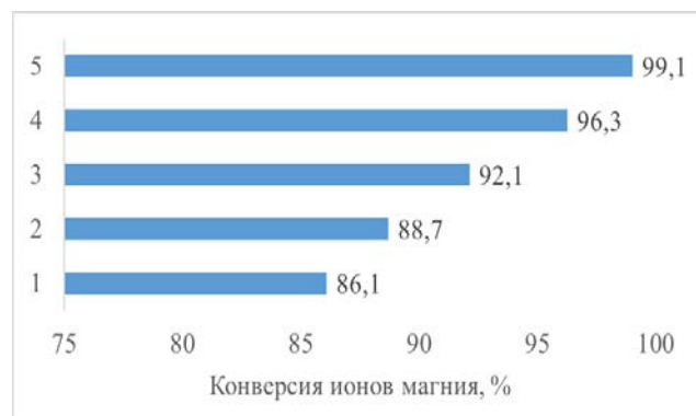
Рис. 1 Конверсия ионов магния в зависимости от стехиометрического отношения NH 4 Cl по стехиометрии реакции (2).
