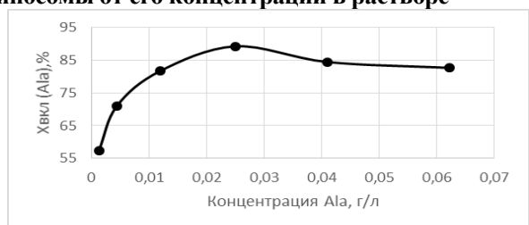
Рис. 2. Зависимость степени включения Ala в липосомы от его концентрации в растворе
