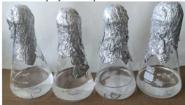
Рис. 1. Колбы с минеральной средой, культурой 8.1 и предобработанным пластиком.
