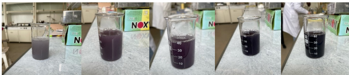
Рисунок 1. – Результаты проверки на наличие крахмала в надосадочной жидкости в ходе пяти последовательных отмывок.
