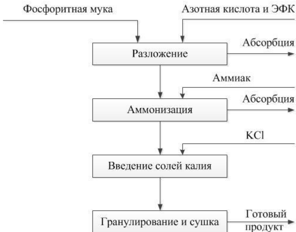
Рисунок 2.12. Схема получения NPK-удобрения без стадии отделения нерастворимого остатка.
