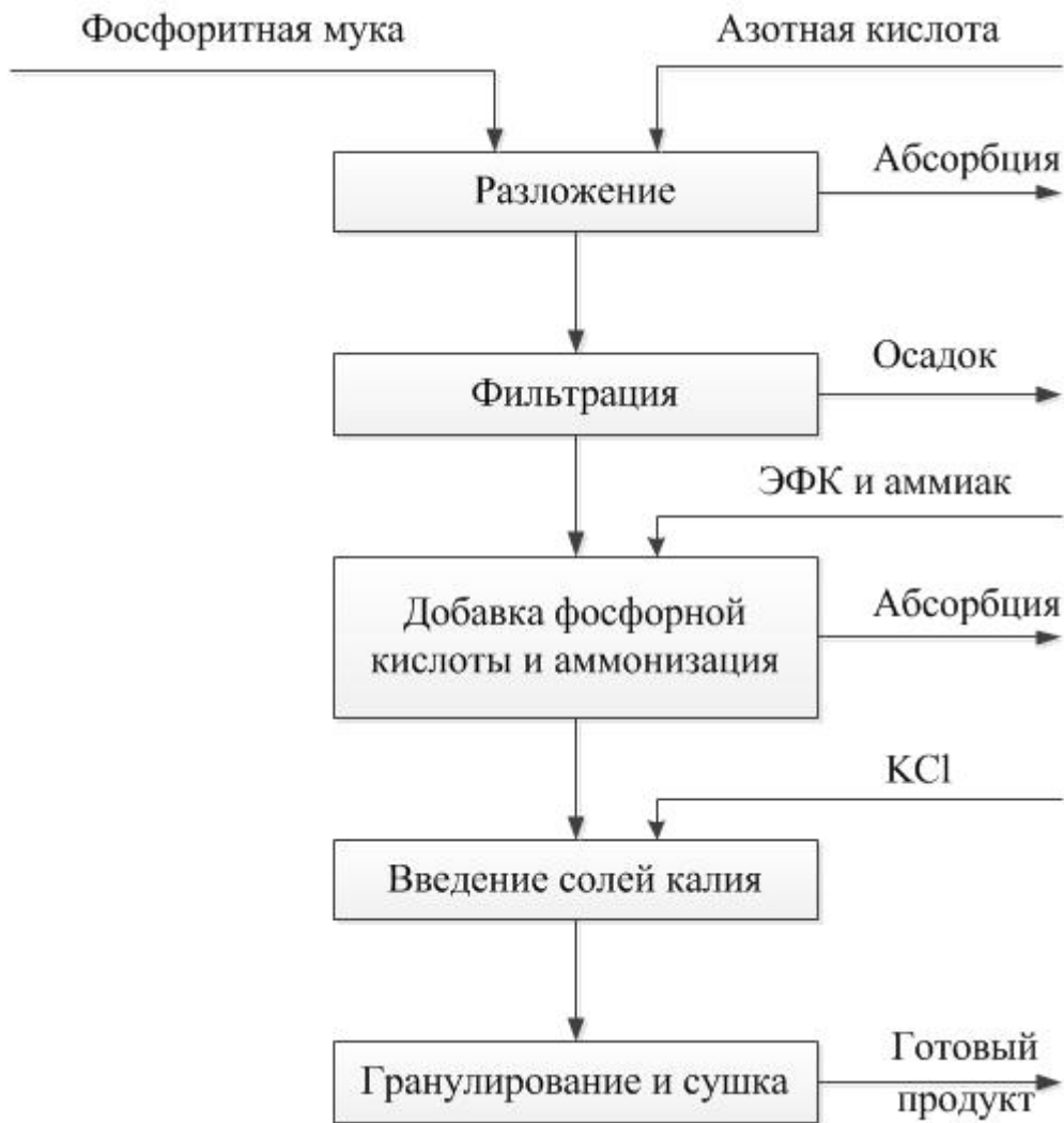
Рисунок 2.13. Схема получения NPK-удобрения с отделением нерастворимого остатка.
