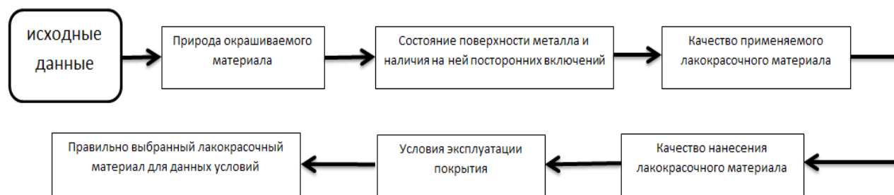
Рис. 1. Факторы, влияющие на долговечность лакокрасочного покрытия
