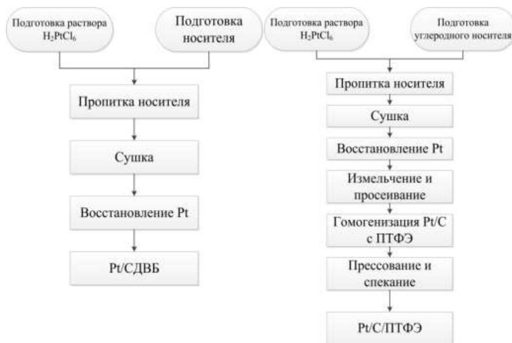
Рисунок 1.4. Схема приготовления гидрофобного катализатора: слева - Pt/СДВБ; справа - Pt/С/ПТФЭ.
