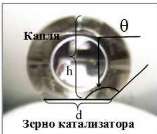
Рисунок 2.1. Изображение капли воды на поверхности носителя:
