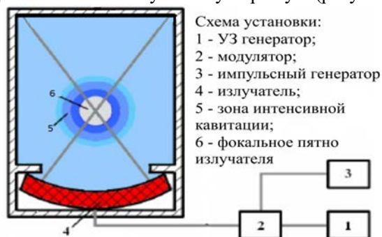
Рис.3. Схема установки ультразвукового воздействия [4]
