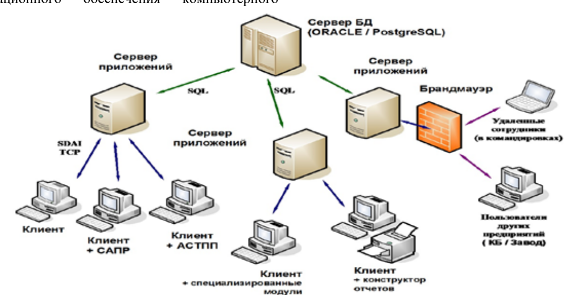
Рис. 1. Трехуровневая архитектура "Клиент-Сервер" в PDM STEP Suite
