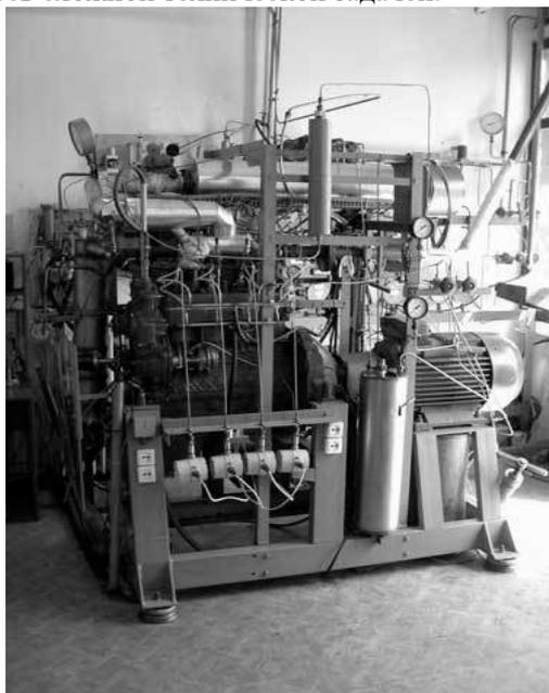
**Рисунок 1. Генератор синтез-газа ОИВТ РАН на базе модифицированного дизельного двигателя**
