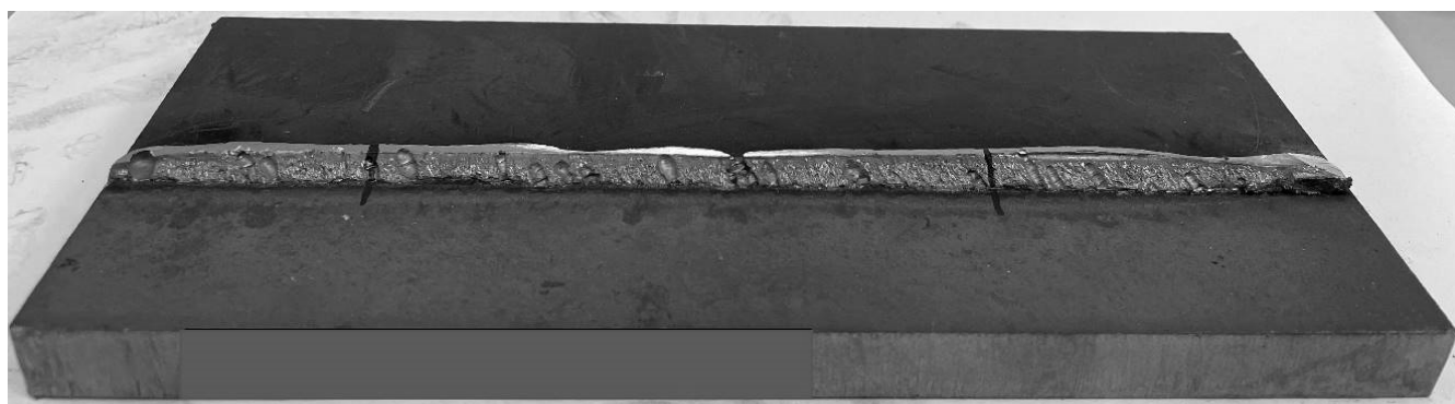
Рис. 2. Внешний вид излома сварного шва
