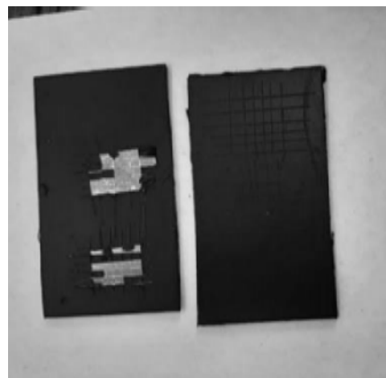
Рис. 3. Внешний вид покрытий после определения адгезии к алюминиевой подложке: слева – содержание АГМ-9 – 0%, справа – 2 мас. %
