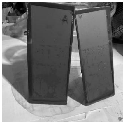
Рис. 5. Внешний вид покрытий после испытаний на устойчивость к кислотной среде: слева содержание АГМ-9 – 2 мас. %, справа – 0 мас. %
