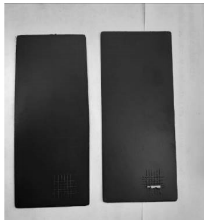
Рис. 2. Внешний вид покрытий после определения адгезии к стальной подложке: слева – содержание АГМ-9 – 2 мас. %, справа – 0 мас. %
