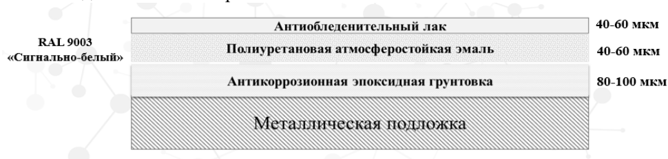
Рис. 1. Предлагаемая схема антикоррозионного антиобледенительного лакокрасочного покрытия
