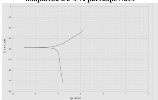
Рис.2. Поляризационные кривые для цинк-полимерного покрытия в 3-х % растворе NaCl
