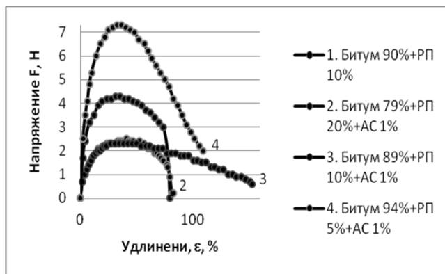
Рис. 1. Динамометрические кривые битумно-резиновых вяжущих
