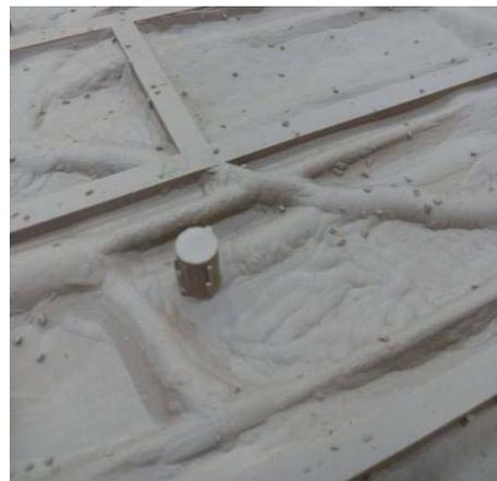
**Рис. 5. Дефект поверхности литого изделия в виде «песчинка»**
