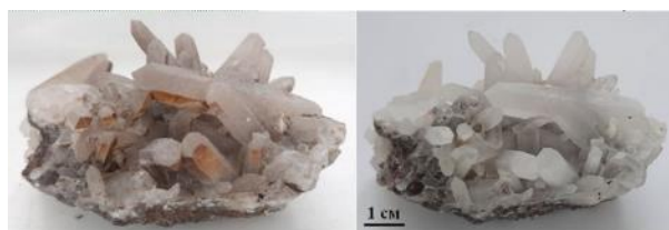
Рис.5. Кварцевая друза до и после травления в смеси HF с лимонной и уксусной кислотами на протяжении 10 минут и в HCl - 1 сутки.
