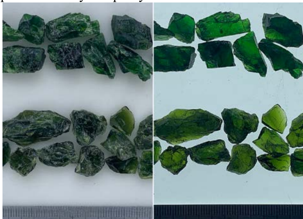
Рис. 1. Хромдиопсид Инаглинского месторождения в отраженном (слева) и проходящем (справа) свете. На второй фотографии можно оценить различия в цвете кристаллосырья одного месторождения (зеленый и, ниже, «болотный» цвет), что в свою очередь объясняется разным примесным составом хромдиопсида
