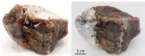
Рис.3. Штуфная проба (образец 3) турмалина Малханского месторождения до и после удаления поверхностных загрязнений. Исходная степень обнажения кристалла турмалина - 60%, степень обнажения кристалла после травления - 90%
