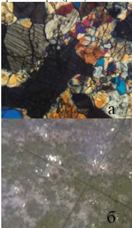
Рис. 1. Тонкий шлиф в проходящем свете при скрещенных поляроидах: а – исходный образец жадеита, б – термообработанный образец со следами распада жадеита на альбит-нефелиновую фазу.
