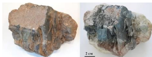
Рис.6. Кристалл топаза до и после травления сутки в смеси HCl и HF в соотношении 1:1. Исходная степень обнажения кристалла - 20%, степень обнажения после травления - 70%.
