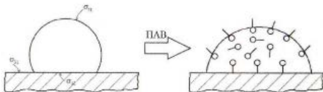
Рис. 1. Адсорбция молекул ПАВ на межфазных поверхностях при смачивании.
