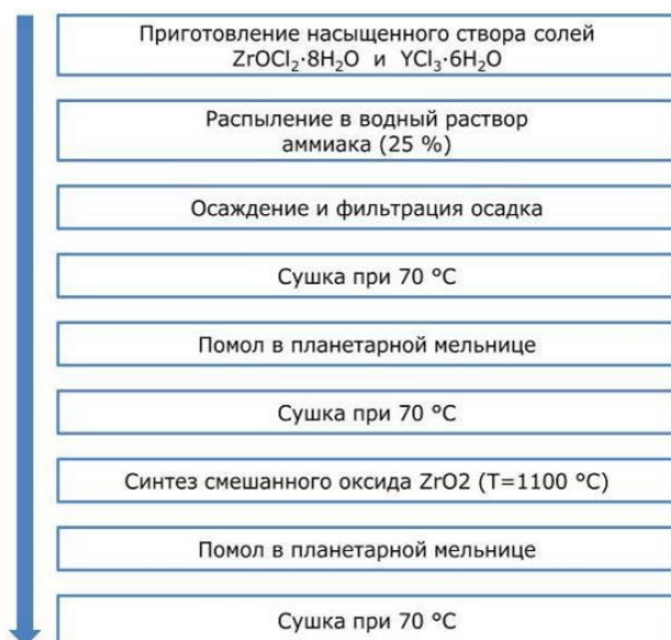
Рис.1. Технологическая схема синтеза порошка стабилизированного диоксида циркония.
