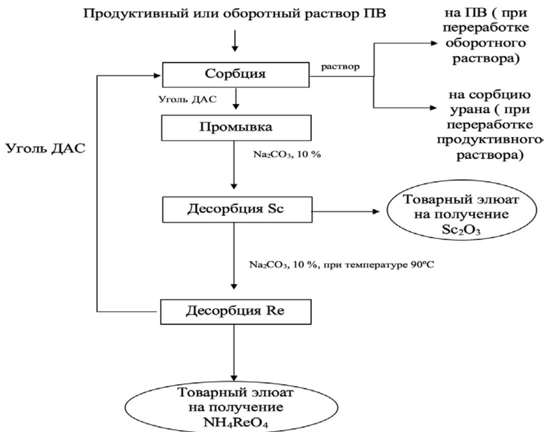
Рисунок 76. Последовательность операций извлечения рения активированным углем ДАС из сернокислых растворов подземного выщелачивания урановых руд Далматовского месторождения
