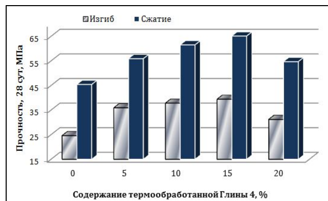
Рис. 2. Прочностные характеристики Глины 4 после твердения 28 суток
