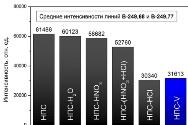
Рис. 3. Средние значения интенсивностей атомных линий бора для различных образцов НПС
