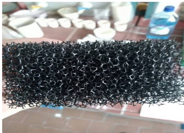
Рис.2. Внешний вид ППУ матрицы с диаметром ячейки 5 мм
