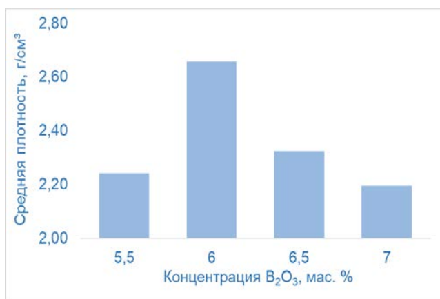
Рис. 4 – Влияние концентрации B_2O_3 на среднюю плотность керамики
