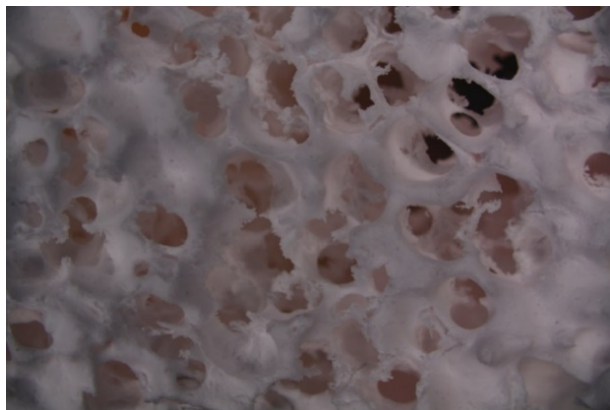
Рис.3. Микроструктура ВПЯМ с увеличением в 30 раз при температуре обжига 1500 °С
