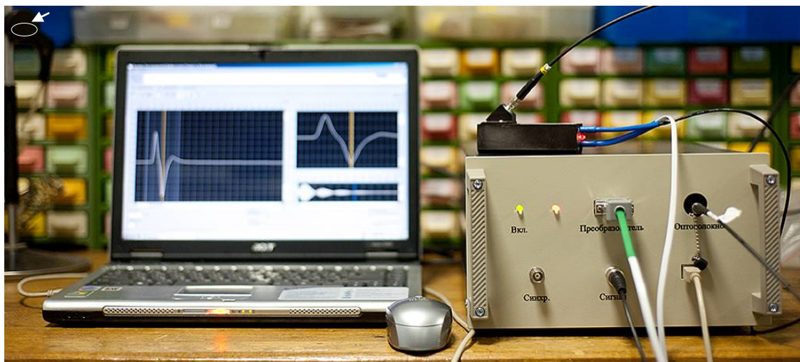
Рисунок 2 - Внешний вид лазерно-ультразвукового дефектоскопа УДЛ-2М
