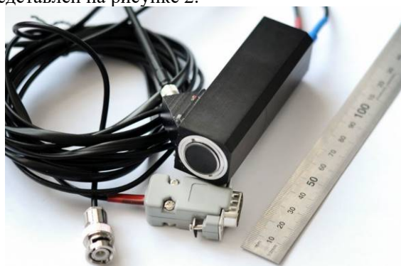
Рисунок 2 - Внешний вид широкополосного оптико-акустического преобразователя ПЛУ-6П-01
