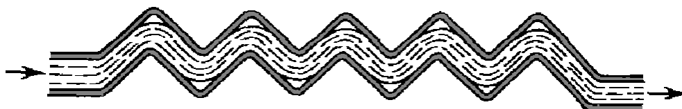
Рис.16.8. Характер движения потока жидкости в канале, образованном двумя соседними гофрированными пластинами
