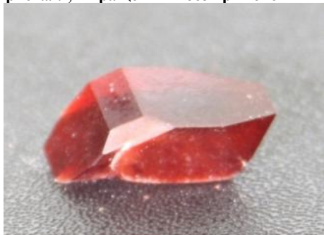
Рис. 3 Кристалл, выращенный без применения вибраций
