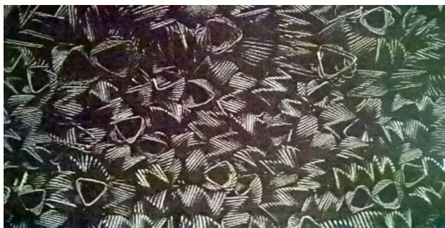
Рис. 1. Внешний вид проволочного ячеисто-каркасного металлического носителя.
