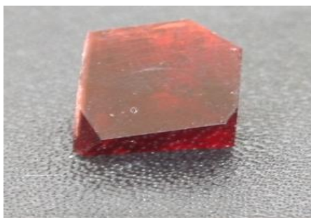
Рис. 3 Кристалл, выращенный без применения вибраций
