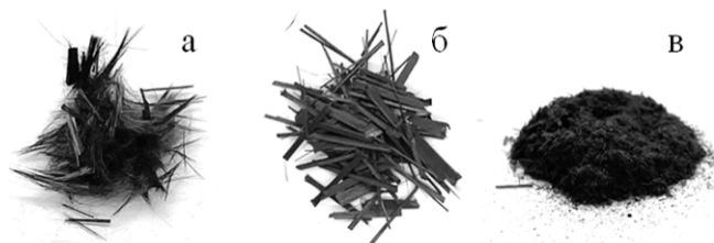
Рисунок 1. Внешний вид углеродных наполнителей: вторичного углеродного волокна (а), рубленого отхода углепластика (б) и молотого отхода углепластика (в).
