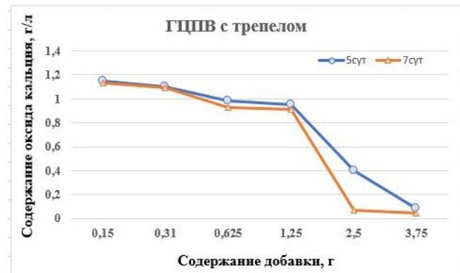
Рис. 1 Зависимость оксида кальция, поглощенное активной минеральной добавкой, от ее содержания в гипсоцементно-пуццолановом вяжущем разного состава
