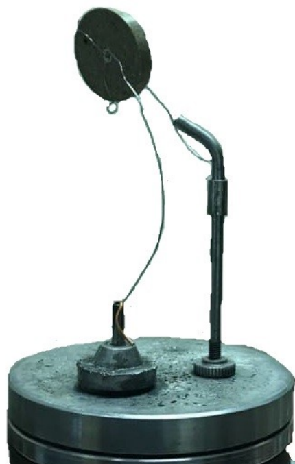
Рисунок 2. Заряд ТАГН/ПУ(7%), закрепленный на нихромовую нить
