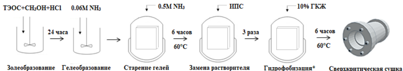
Рис. 1. Принципиальная схема получения аэрогелей (* - стадия для получения гидрофобных аэрогелей)
