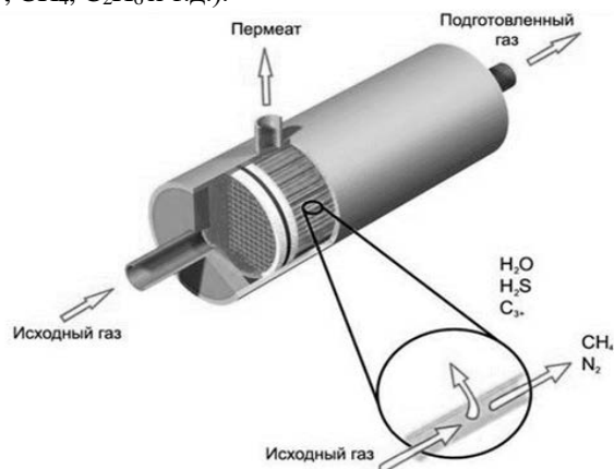
Рис.2 Схематическое изображение газоразделительного модуля
