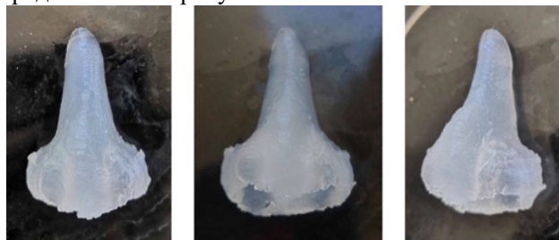
Рис. 2. Результат реализации процесса прямой гелевой печати с использованием раствора частично сшитого альгината натрия с концентрацией сшивающего агента 0,20 масс.%.
