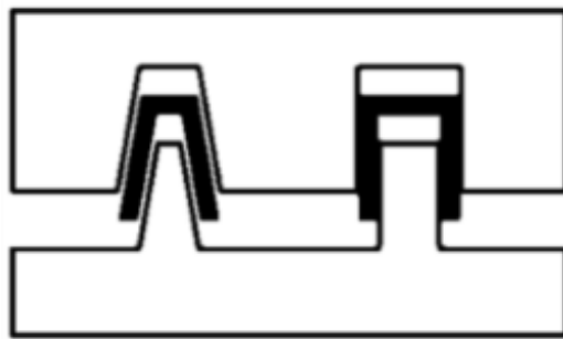
Рис. 3. Иллюстрация процесса извлечения изделия из формы в зависимости от конструкции ФОД
