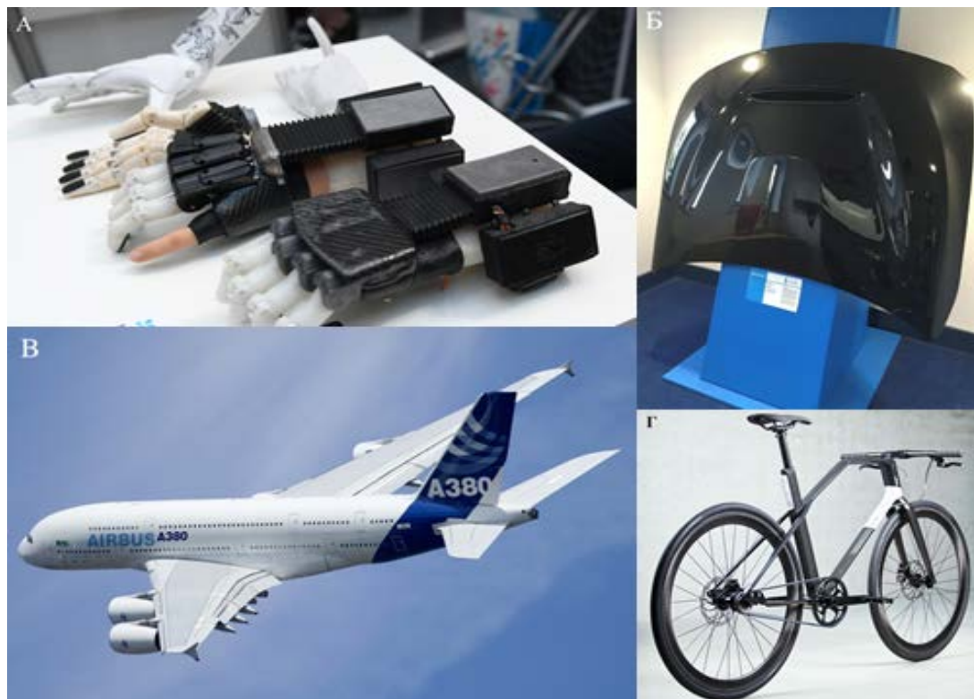
Рис. 1. Области применения углепластика: А - медицинские протезы; Б - капот двигателя для BMW машин; В - хвостовое оперение в самолетах А380; Г - рама велосипеда
