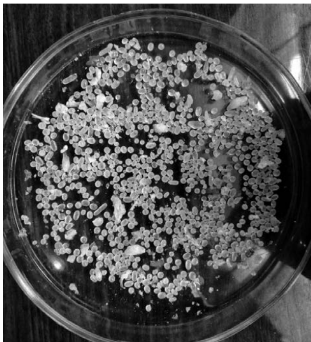
Рис.4. Гранулы поливинилового спирта, сшитого глутаровым альдегидом
