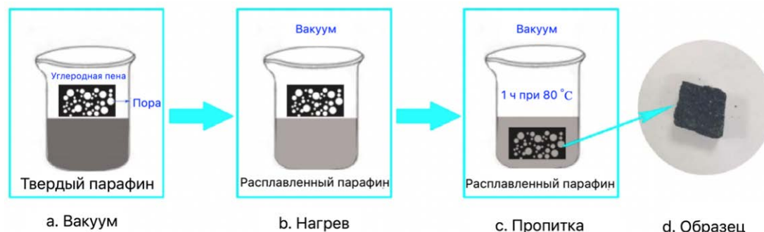
Рис. 2 Схема вакуумной пропитки образцов углеродной пены [1]
