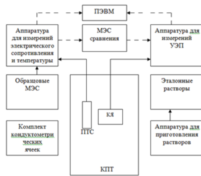
Рис. 2 Структурная схема эталона: КЯ – кондуктометрическая ячейка, ПТС – платиновый термометр сопротивления, КПТ – рабочая камера прецизионного термостата
