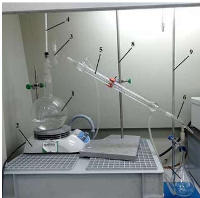
Рис. 1 Установка для проведения простой перегонки: 1 – колба; 2 – электрическая плита; 3 – насадка Кляйзена; 4 – термометр; 5 – холодильник Либиха; 6 – алонж; 7 – приёмник; 8,9 – штатив
