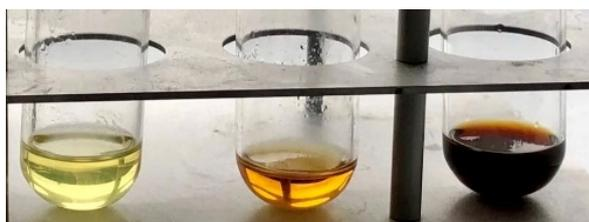
Рис. 4. Внешний вид реакционной массы при 150°C, 170°C и 190°C (слева направо)
