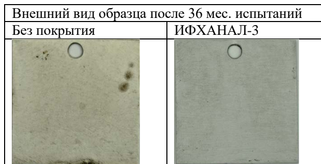
Рис. 2. Внешний вид образцов без и с конверсионными покрытиями на сплаве АМг3 после 36 мес. натуральных испытаний на КИС Хоа Лак, Ханой, Вьетнам.
