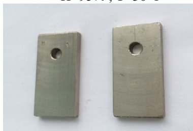
Образцы никеля после испытаний при Н=70%, Т=20°C; Н=95%, Т=50°C
