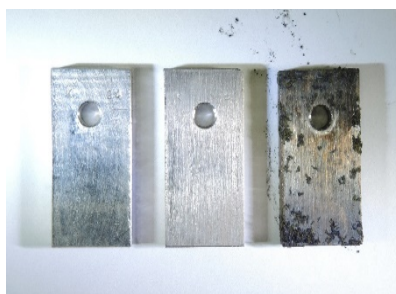
Образцы кобальта после испытаний при: Н=70%, Т=50°C; Н=70%, Т=20°C; Н=95%, Т=50°C
