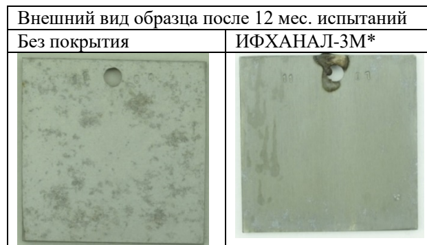
Рисунок 3. Внешний вид образцов без и с конверсионными покрытиями на сплаве 1105 после 12 мес. натуральных испытаний на КИС Хао Лак в г. Ханой, Вьетнам.
