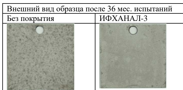
Рис. 3. Внешний вид образцов без и с конверсионными покрытиями на сплаве Д16 после 36 мес. натуральных испытаний на КИС Хоа Лак, Ханой, Вьетнам.
