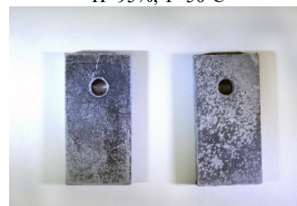
Образцы свинца после испытаний при: Н=70%, Т=20°C; Н=95%, Т=20°C
