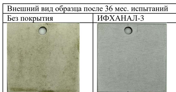
Рис. 1. Внешний вид образцов без и с конверсионными покрытиями на сплаве АМц после 36 мес. натурных испытаний на КИС Хоа Лак, Ханой, Вьетнам.
