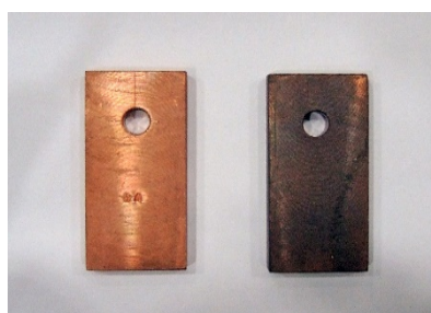
Образцы меди после испытаний при: Н=70%, Т=20°C; Н=95%, Т=50°C
