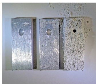
Образцы цинка после испытаний при: Н=70%, Т=20°C; Н= 70%, Т= 50°C; Н=95%, Т=50°C
