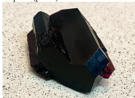
Рис 1. Полученные монокристаллы Rb_2CoCl_4 \cdot 2H_2O .
