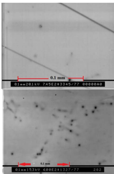
Рис. 2. Изображение поверхности скола в режиме интегральной катодолюминесценции (а – первая группа, б – вторая группа)
