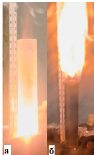
Рис. 5. Эффекты при вспышке образцов: а – без УНТ; б – с УНТ
