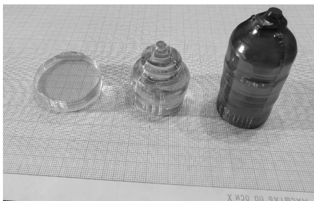
Рис. 1 Кристаллы вольфрамата кадмия разного состава. Количество Cd увеличивается справа налево, прозрачный кристалл ближе всего к стехиометрическому составу.
