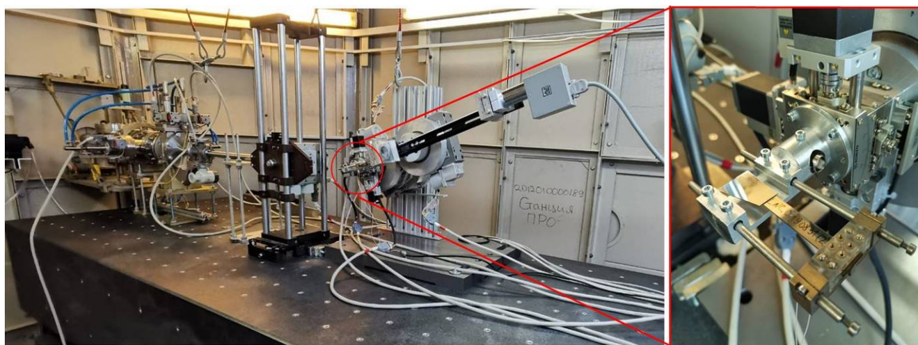
Рис. 2. Внешний вид рентгенооптической части станции и АЭРО на основе изгибного пьезоактуатора в кристаллодержателе.
