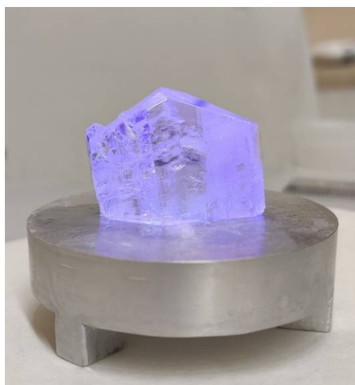
Рис. 1. Монокристалл транс -стильбена на ростовой платформе: а – вид сбоку; б – вид сверху.
