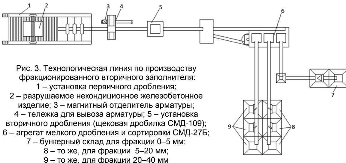
Рис. 3. Технологическая линия по производству фракционированного вторичного заполнителя:
