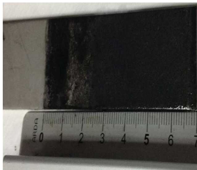
Рис. 1. Фотография титанового катода с выделившимся на нем порошкообразным кадмием.
