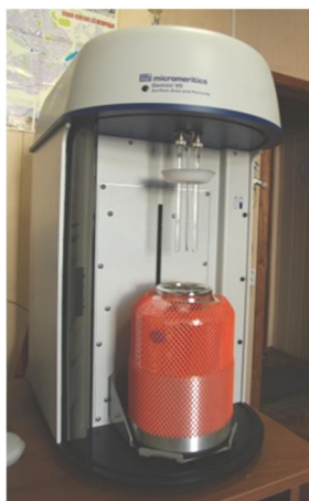
Рис. 7.8. Размещение сосуда Дьюара в анализаторе
