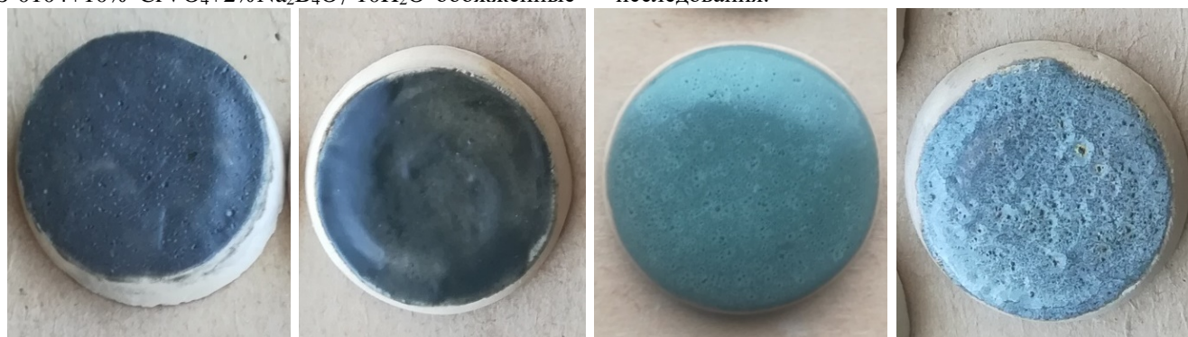
а) 800°C черный, металлический блеск б) 900°C черный, глянцевый в) 1000°C серо-голубой, глянцевый, с вкраплениями г) 1100°C голубой, глянцевый, с вкраплениями
