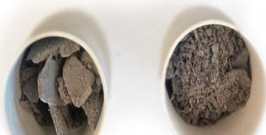
Рис. 1 Внешний вид образцов пигмента состава \text{Co}_x\text{Zn}_{2-x}\text{SiO}_4 а- до синтеза и б – после синтеза
