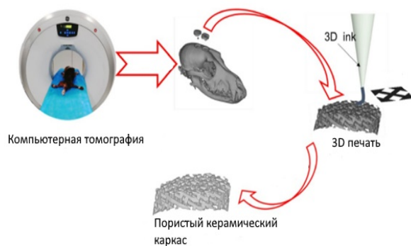
Рис.2 – схема печати кальцийфосфатной биокерамики[3]
