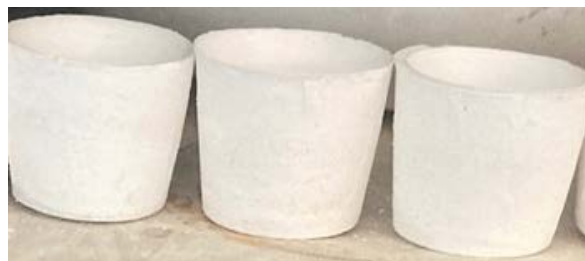
Рис. 3 Отлитые в течение 10 минут тигли
