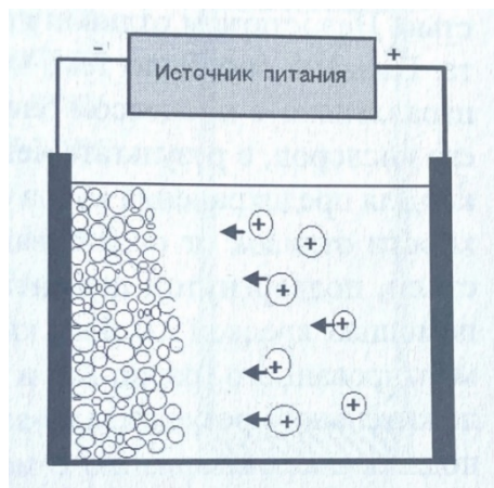
Рис.3. Схема установки для формирования с применением электрофореза [4]
