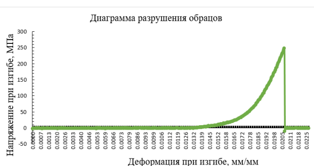
Рис. 2. Диаграмма «напряжение – деформация» для образцов с содержанием железа 32 мас.%
