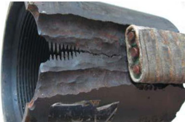
Рис. 2. Электрохимическая коррозия муфты НКТ.
