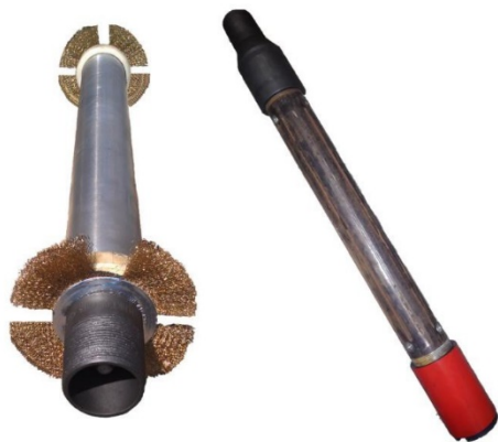
Рис. 6. Устройство защиты погружной насосной установки от коррозии
