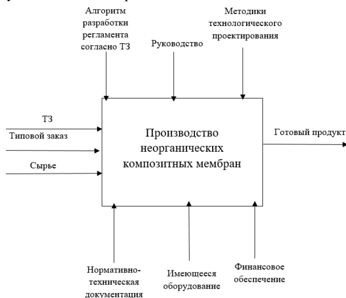
Рис.1 Контекстная диаграмма по производству неорганических композитных мембран
