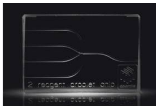
Рис. 1. Двухреагентный капельный микрофлюидный чип компании Dolomite Microfluidics;
