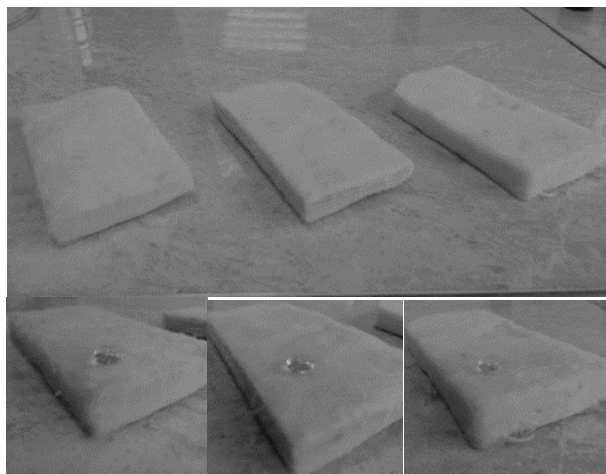
Рис.4 Фотографии полученных аэрогелей: а) 3% ТМХС; б) 4% ТМХС; в) 5% ТМХС.
