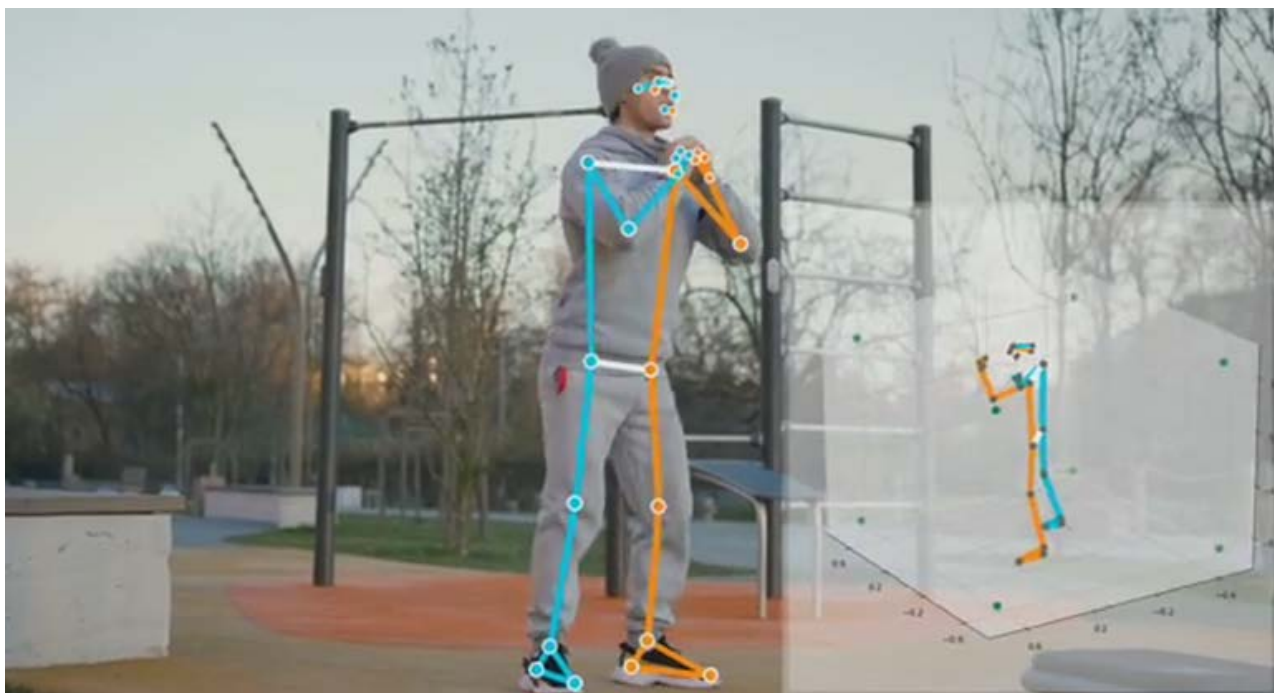
Рис. 2. Пример работы распознавания MediaPipe Pose с реальными 3D координатами.
