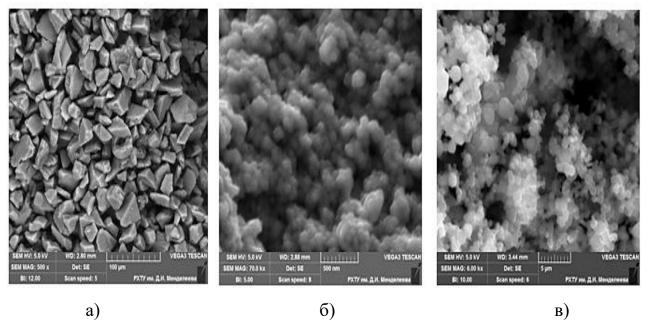
Рис. 6.1. Микроструктура РЭМ исходных порошков а) — электроплавленный корунд марки F-1000; б) —  $ZrO_2$  (3,0 моль% $Y_2O_3$ ); в) — эвтектическая добавка  $Al_2O_3$ - $TiO_2$ -MnO.
