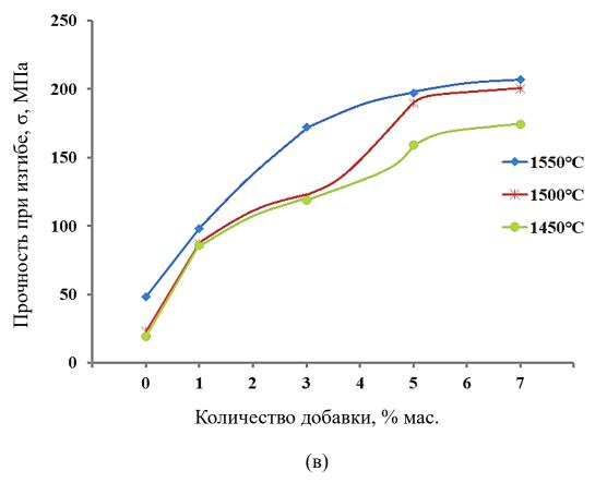
Рис 3.1.3. Изменение пористости (а), линейной усадки (б) и прочности при изгибе (в) образцов композиционной керамики в зависимости от содержания добавки и температуры обжига.
