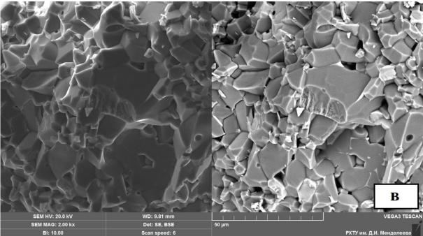
Рис. 5.1.5. Микроструктура (РЭМ) образцов после спекания при  $1550^{\circ}$ С а) – количество эвтектической добавки 1%; б) – 7%; в) – 15% мас.
