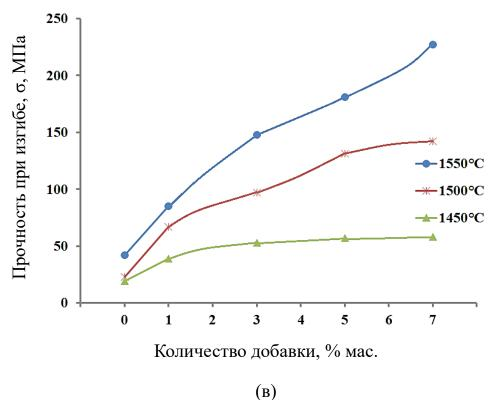
Рис 5.1.4. Изменение пористости (a), линейной усадки (б) и прочности при изгибе (в) образцов композиционной керамики в зависимости от содержания добавки и температуры обжига
