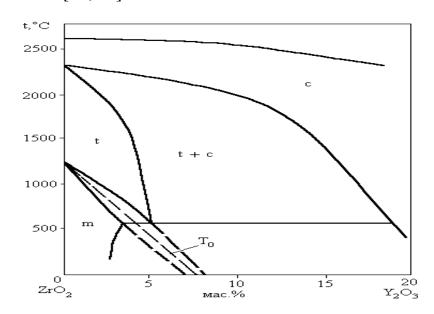
Рис. 1.8. Диаграмма состояния системы  $ZrO_2$ — $Y_2O_3$ :  $T_0$  — температура перехода m- $ZrO_2$   $\leftrightarrow$  t- $ZrO_2$
