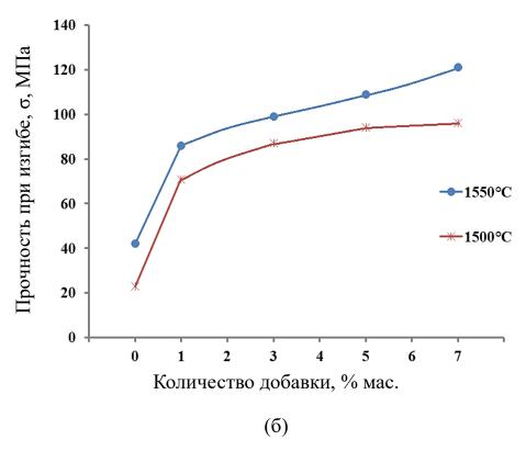
Рис 5.2.2. Изменение пористости (а), линейной усадки (б) и прочности при изгибе (в) образцов композиционной керамики в зависимости от содержания добавки и температуры обжига
