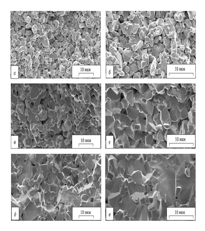
Рис. 4.3. Микроструктура образцов чистого корунда  $(a, \delta)$  и композиционных керамических образцов с содержанием добавки 3%  $(e, \epsilon)$  и 15 % (d, e), (a, e, d) температура обжига – 1500°C,  $(b, \epsilon, e)$  – 1550°C.
