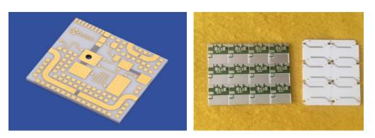
Рис. 1.2. Керамические подложки для электрических интегральных схем
