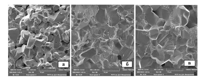
Рис. 6.2. Микроструктура РЭМ спеченных образцов,  $T_{cn.} = 1550$ °C (скол)
