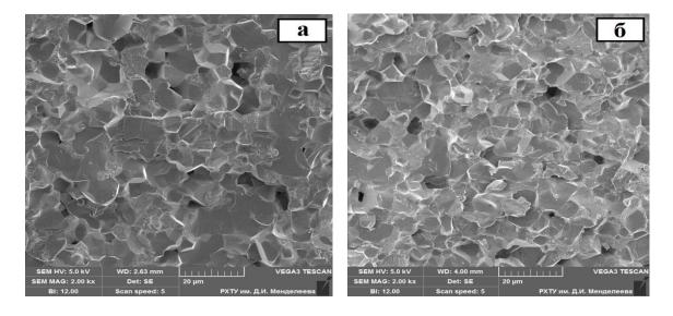
Рис. 6.4. Микроструктура РЭМ спеченных образцов,  $T_{cn.}$  = 1550°C (скол);
