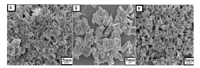
Рис. 3.2.1. Фотографии микроструктуры порошков а) эвтектическая добавка, б) – электроплавленный корунд F–600, в) – шихта после миханоактивация в планетарной мельнице.
