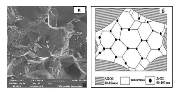
Рис. 6.5 а) — Микроструктура РЭМ спеченного образца ЭПК+ 20%  $ZrO_2$  (3,0 моль% $Y_2O_3$ )+ 5% эвтектической добавки; б) — схематическое изображение структуры материала типа «композит в композите».
