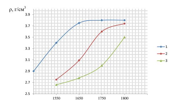
Рис. 1.7. Дисперсности чистого корунда в зависимости от плотности керамики и температуры спекании  $1-d_{\rm cp}=1,0$  мкм;  $2-d_{\rm cp}=2,4$  мкм;  $3-d_{\rm cp}=5,6$  мкм;  $\tau=2$  часа
