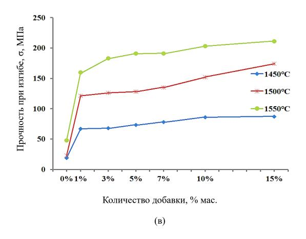
Рис. 4.2 Изменение открытой пористости (а), линейной усадки (б) и предела прочности при изгибе (в) образцов композиционной керамики зависимости от количества добавки и температуры обжига (указана на кривых, °С).
