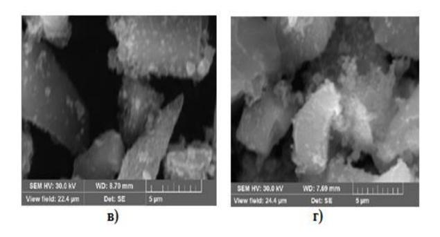
Рис. 5.1.2. Распределение частиц по размерам эвтектической добавки (а); микроструктура порошка (РЭМ) эвтектической добавки после синтеза (б); микроструктура (РЭМ) композитной шихты с 1% добавки (в) и микроструктура (РЭМ) композитной шихты с 7% добавки (г).
