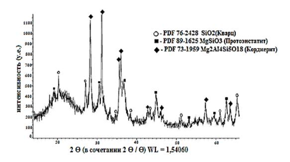
Рис. 5.1.3. Рентгенограмма порошка эвтектического состава в системе  $Al_2O_3$ -  $MgO\text{-}SiO_2$
