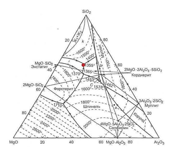
Рис 5.1.1. Диаграмма состояния в системе  $Al_2O_3$ -MgO-SiO $_2$
