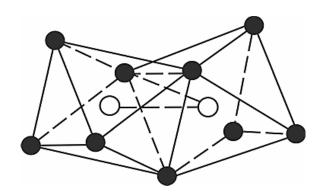
Рис. 1.3. Элементная структура корунда [15].
