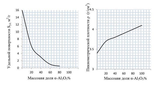
Рис. 1.6. Зависимость удельной поверхности  $S_{yд}$  (a) и пикнометрической плотности  $\rho$  (б) порошка оксида алюминия от содержания в нем  $\alpha$ -Al<sub>2</sub>O<sub>3</sub>
