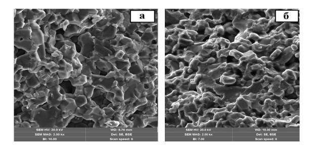
Рис. 6.3. Микроструктура РЭМ спеченных образцов  $T_{cn.}$ =1550°C (скол) а) – ЭПК+ 2% эвтектической добавки; б) – ЭПК+ 5% эвтектической добавки.
