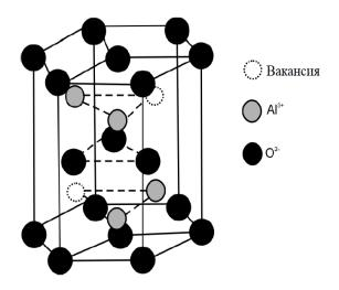
Рис. 1.4. Кристаллическая структура корунда ( $\alpha$ -Al<sub>2</sub>O<sub>3</sub>)
