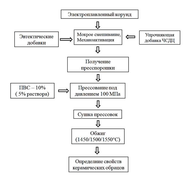
Рис 2.2. Технологическая схема получения композиционных керамических материалов на основе электроплавленного корунда
