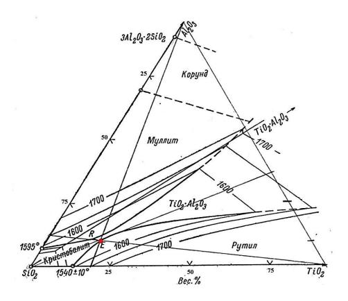
Рис 5.2.1. Диаграмма состояния в системе  $Al_2O_3$ -  $SiO_2$ - $TiO_2$
