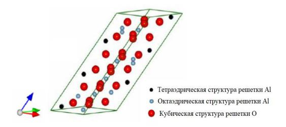
Рис. 1.5. Структура  $\gamma$ -Al $_2$ O $_3$  (технический глинозём)
