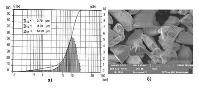
Рис. 3.1.1. Распределение частиц по размерам (а) и микроструктура электрокорунда марки F-1000, полученная с помощью растрового электронного микроскопа (РЭМ) (б) ( $D_{10}$ ,  $D_{50}$ ,  $D_{90}$  – диаметры частиц в мкм при определенном их количестве в %)
