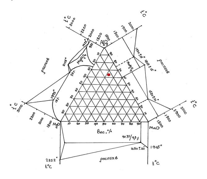
Рис 4.1. Диаграмма состояния в системе  $Al_2O_3$ –MgO–MnO
