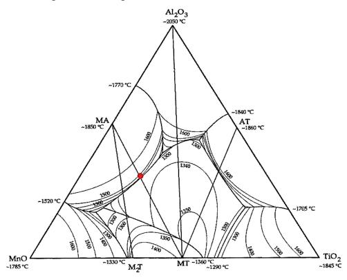
Рис. 3.1.2. Диаграмма состояния в системе  $Al_2O_3$ - $TiO_2$ -MnO
